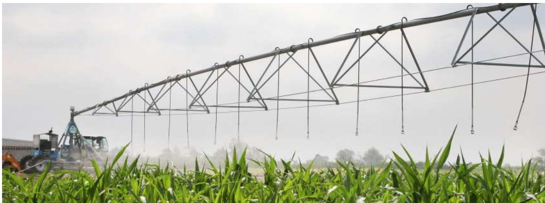
Der Centerliner mit einer Systemlänge von 330 Metern beregnet 88 Hektar.
